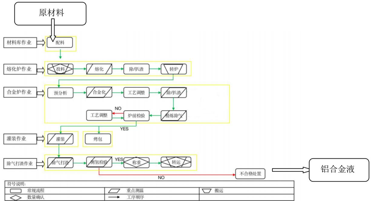
图2 绿色设计平台上建立的铝合金轮毂的LCA模型示意图
